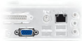
Der ST2-HiFi ist mit Ethernet ausgestattet und kann mit WiFi erweitert werden.
