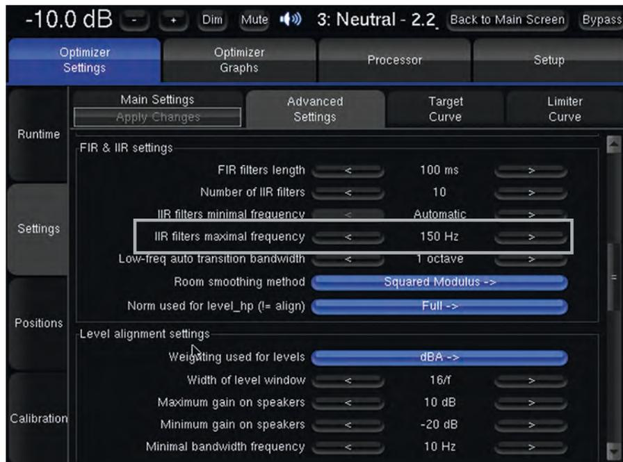
**IIR filters** ("Infinite Impulse Response filter", Filter mit unendlicher Impulsantwort) sind nur für die Beeinflussung des Amplitudengangs im Tieftonbereich bestimmt.
