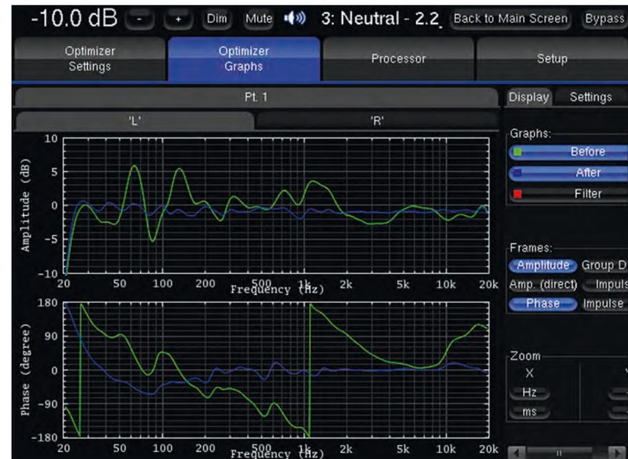
In dieser Darstellung zeigt der grüne Graph das Messergebnis vor - der blaue Graph das Resultat nach der Korrektur an. Frequenzgang (Amplitude) oben - Phasengang unten.
