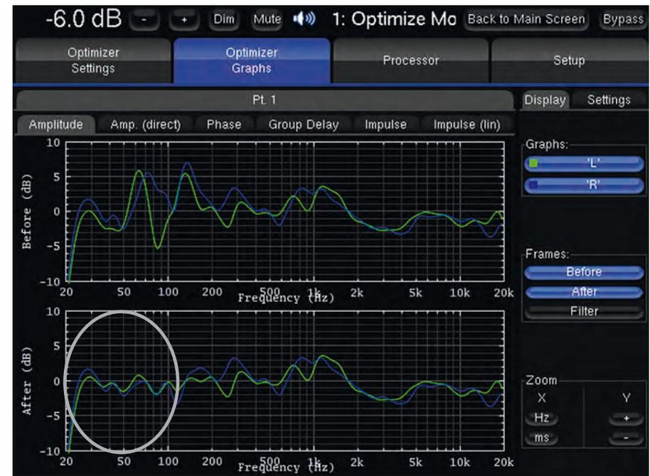
Die Betriebsart **Low Range only** sorgt für keinerlei Korrektur des Phasengangs und kompensiert den Amplitudengang nur bis 150 Hz (standardmäßig).
