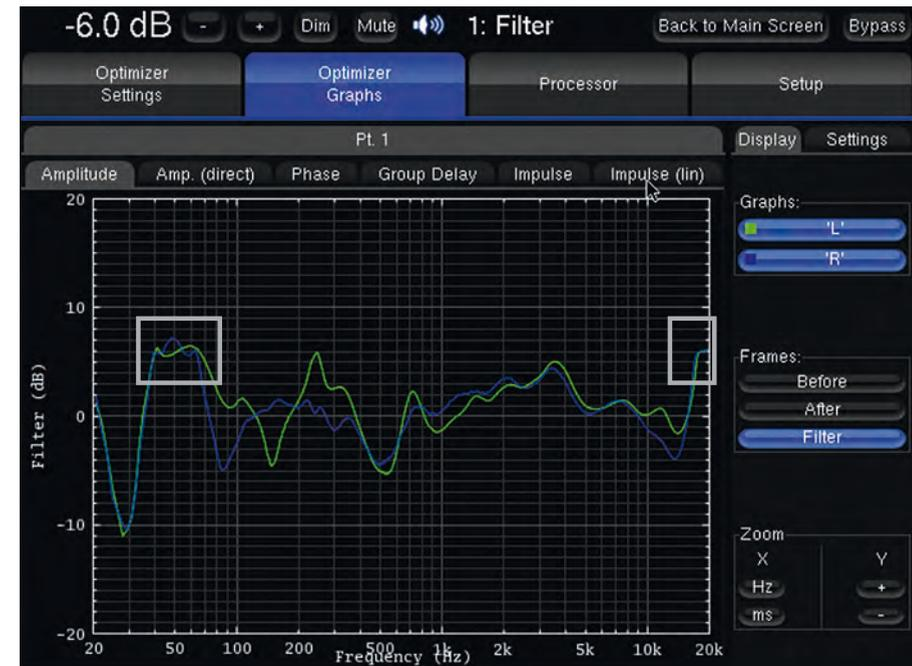
An den hervorgehobenen Ausschnitten kann man die Begrenzung der Bandbreite des Filters auf eine maximale Anhebung von 6dB ablesen.
