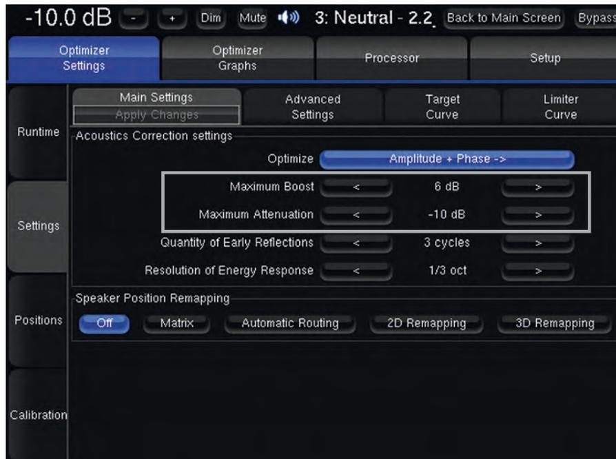
Die Parameter **Maximum Boost** und **Maximum Attenuation** dienen dazu, eine Überkorrektur zu verhindern. Mit den beiden Parametern wird die Bandbreite festgelegt in welcher der Korrekturfilter arbeiten "darf".
