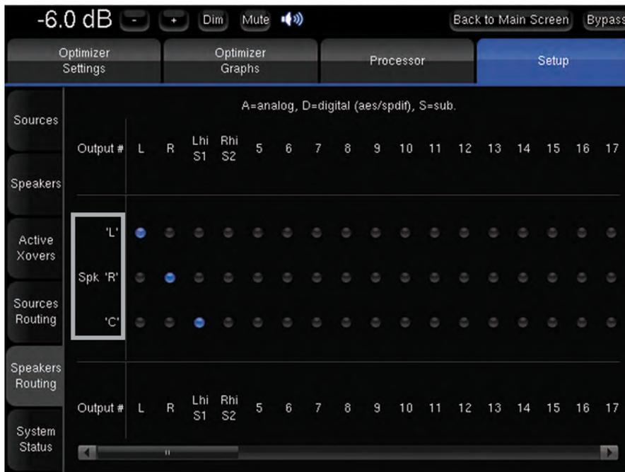
Jede Zeile der Lautsprecherschema-Matrix repräsentiert einen Quellenkanal und ist abhängig sowohl vom Quellenformat wie auch von der Lautsprecherkonfiguration, die in den vorherigen Schritten durchgeführt wurde.
