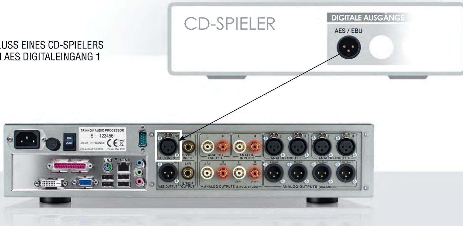
Der ST2-HiFi ermöglicht Ihnen den Anschluss und das Abspielen sämtlicher Stereo-Quellgeräte ohne jegliche Konfiguration.
