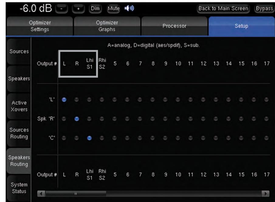
Jede Spalte der Lautsprecherschema-Matrix korrespondiert mit einem physischen Ausgang.
