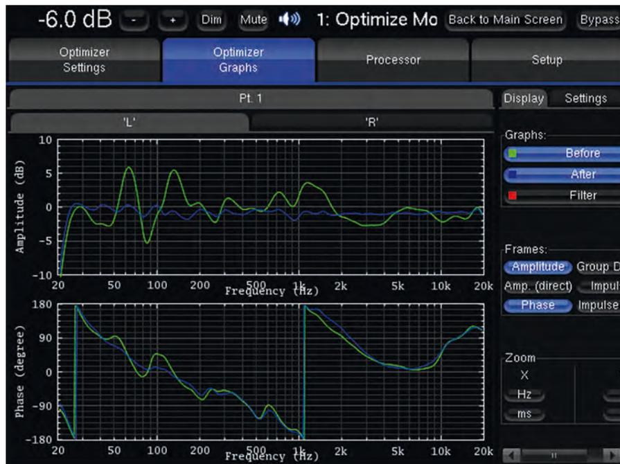
Die Betriebsart **Amplitude only** sorgt nur für eine Korrektur des Amplitudengangs (der Phasengang wird also nicht korrigiert). Daraus resultiert eine geringe räumliche Genauigkeit und Stabilität.
